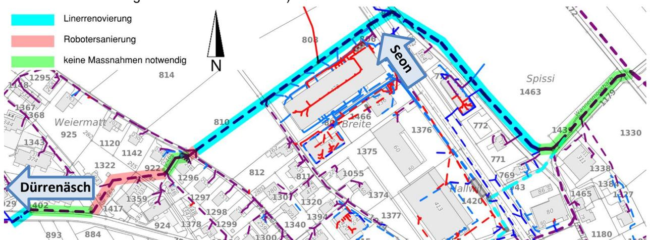
Abbildung 2: Sanierungsbedarf pro Leitungsabschnitt
